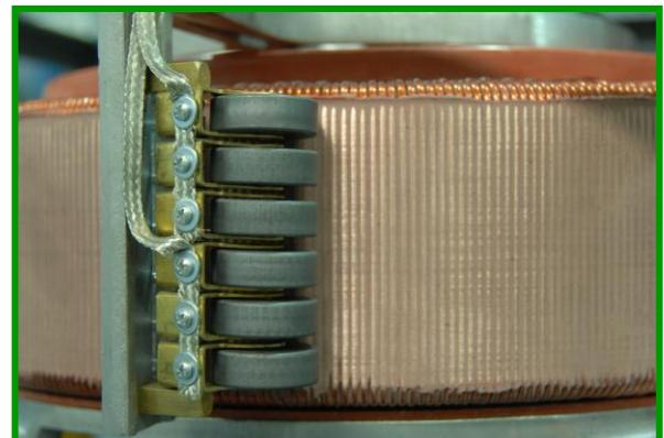
**Токосъемный узел регулятора напряжения – это передовые технологии в данной области. Токосъемная каретка оснащена не щетками, а электрографитовыми роликами, что обеспечивает по сравнению со щетками:**
