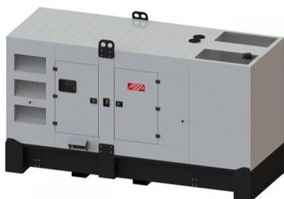
FDF 250 V- трехфазный генератор с номинальной мощностью **160 кВт** в кожухном исполнении. Применяется для электроснабжения потребителей с напряжением 400/230 В. В составе агрегата двигатель Volvo. И синхронный генератор **Leroy Somer** (Франция/Чехия)
